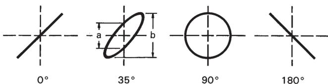
El ángulo de fase y el desfase entre las tensiones X e Y se puede calcular fácilmente (después de medir las distancias **a** y **b** en la pantalla) aplicando las siguientes fórmulas y utilizando una calculadora provista de funciones trigonométricas. Este cálculo **es independiente de las amplitudes de deflexión** en la pantalla.
