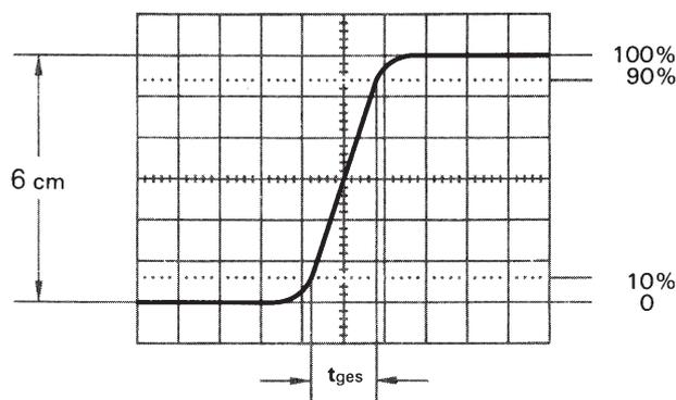
Ajustando un coeficiente de deflexión de 0,2  $\mu$ s/div. en el conmutador TIME/DIV., y pulsando la tecla de expansión x10, el ejemplo del dibujo daría un tiempo de subida total de
