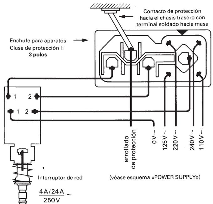
Vista posterior del interruptor de red y del enchufe con el selector de tensión y el portafusibles.
