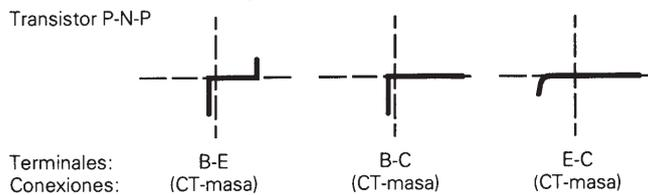
Obsérvese que con la **inversión de los polos de conexión de un semiconductor** (por confusión del borne CT con el borne de masa) se provoca un **giro de la imagen de test de 180°** sobre el centro de la retícula.
