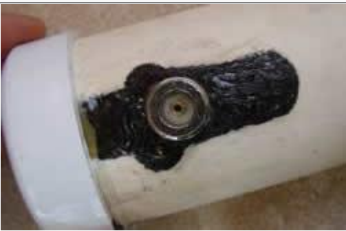
Conector sobresaliendo por la parte inferior de la antena para permitir su conexión
