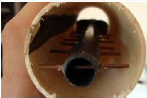
Antena colocada en el interior del caño de PVC
