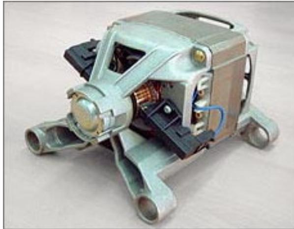
Tienen 2 bobinas y 4 conexiones, en algunos modelos el estator y el rotor pueden venir conexiónados en serie, y entonces el motor presenta solo dos conexiones, pero no es habitual.
