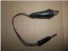
Este Cable, suministrado como parte integral de K119, se proporciona para la conexión a válvulas que tienen casquillo superior y para la inserción en la entrada marcada "TC". (ficha banana)
