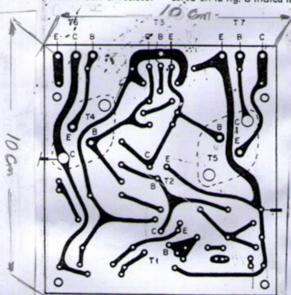
Fig. 166 Plaqueta impresa de medio amplificador (dos por amplificador).
