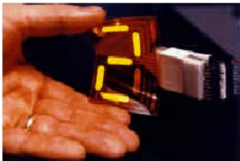
Figura 1-34. Diodo emisor de luz basado en un polímero orgánico. [32]
