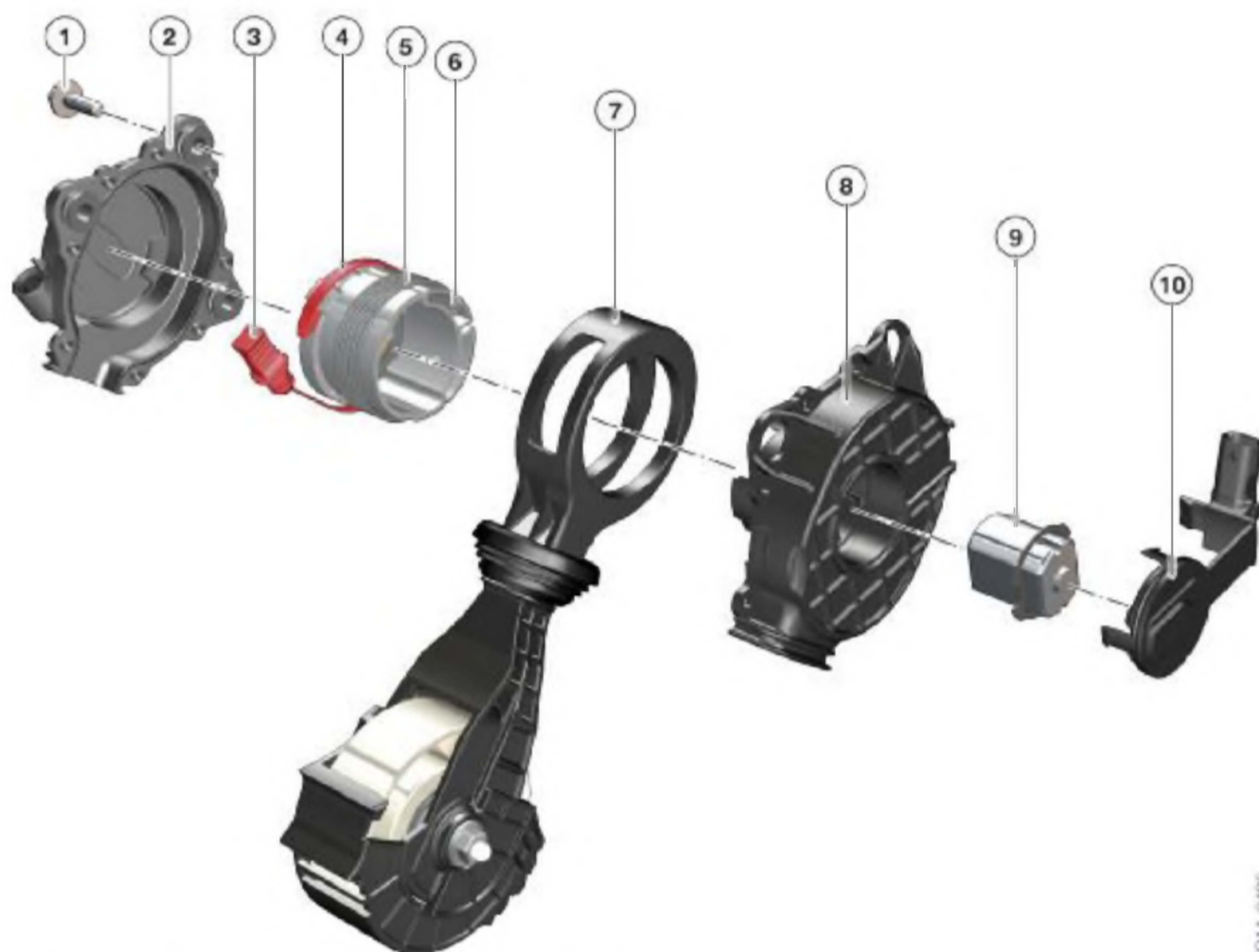
Двигатель N13, привод регулировки фрикционного колеса, детальное изображение
