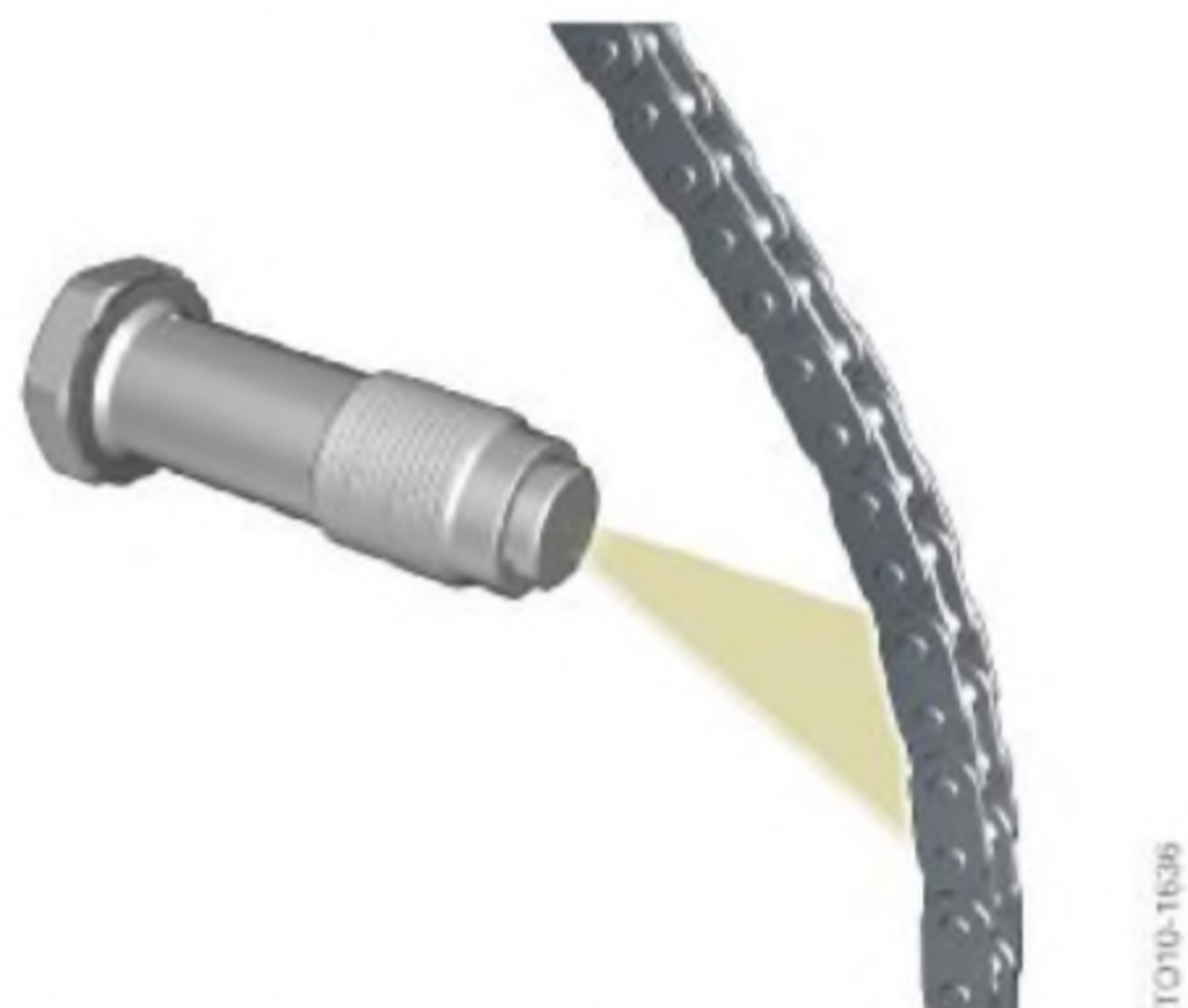
Двигатель N13, натяжитель цепи с масляной форсункой для приводной цепи
