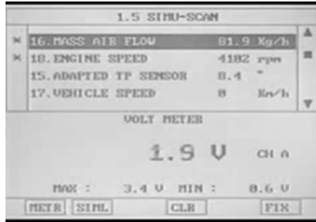
Figura 27: Gráfica del sensor MAF obtenida por scanner
