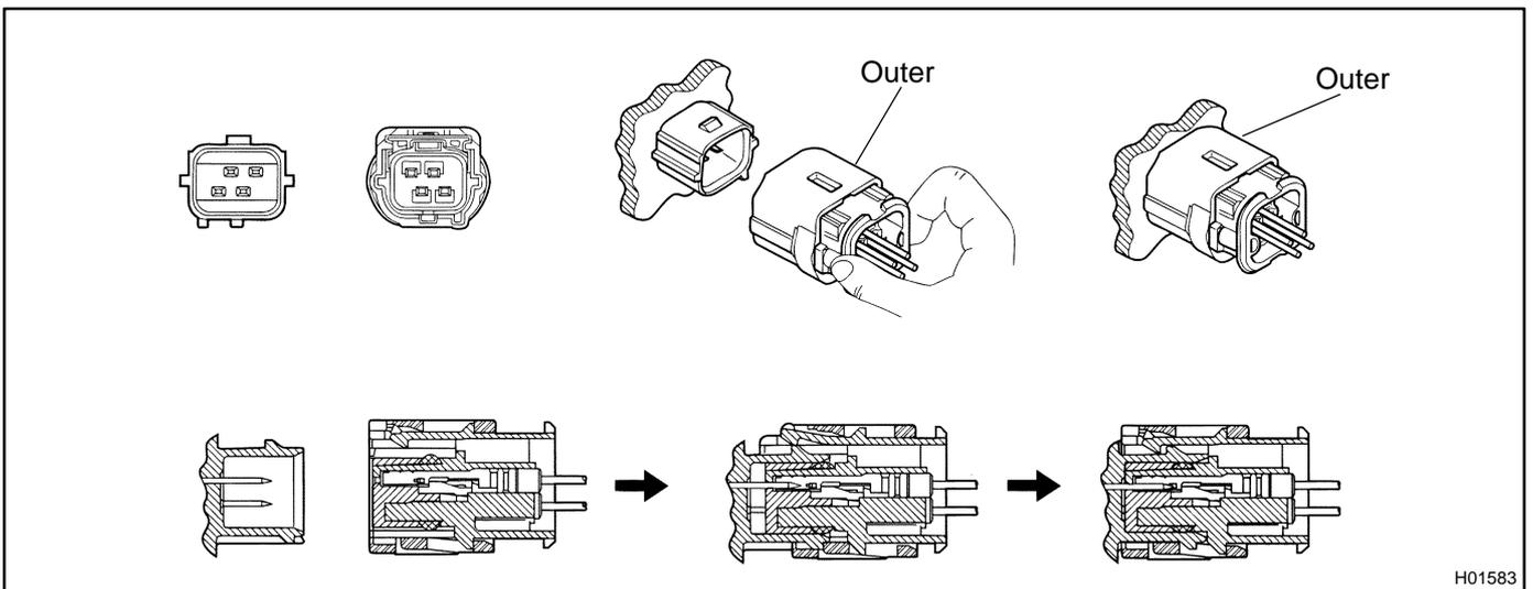
**12. DISCONNECTION OF SIDE AIRBAG CONNECTOR**
