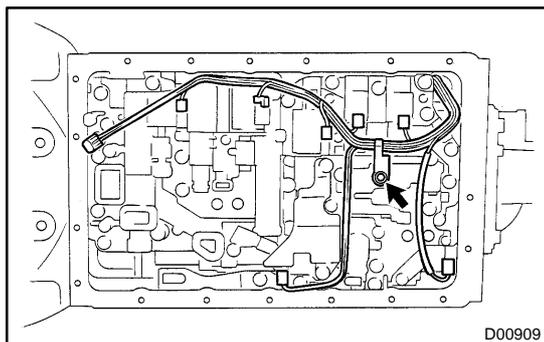
**5. REMOVE SOLENOID WIRING**
