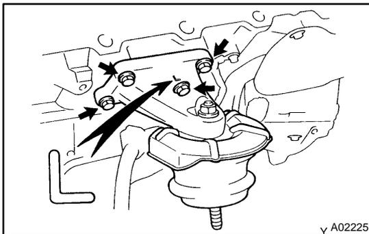
**28. INSTALL LH ENGINE MOUNTING BRACKET**
