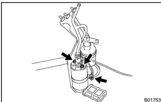
7. REMOVE PUMP SET PLATE FROM FUEL PUMP
