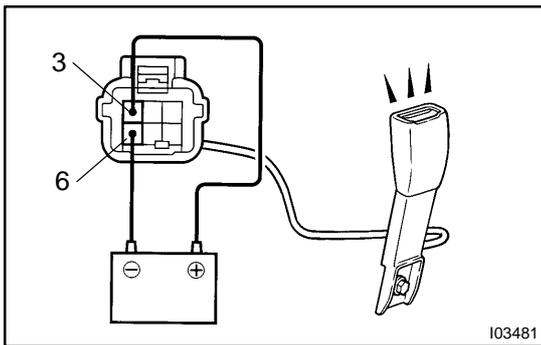
**5. INSPECT BUCKLE SWITCH INDICATOR LIGHT OPERATION**
