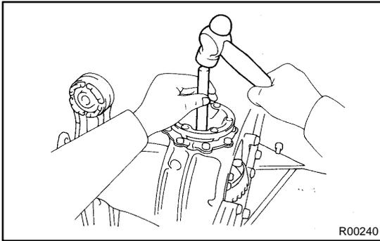
**33. INSTALL SIDE GEAR SHAFTS**
