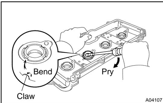
**2. REPLACE SPARK PLUG TUBE GASKETS**
