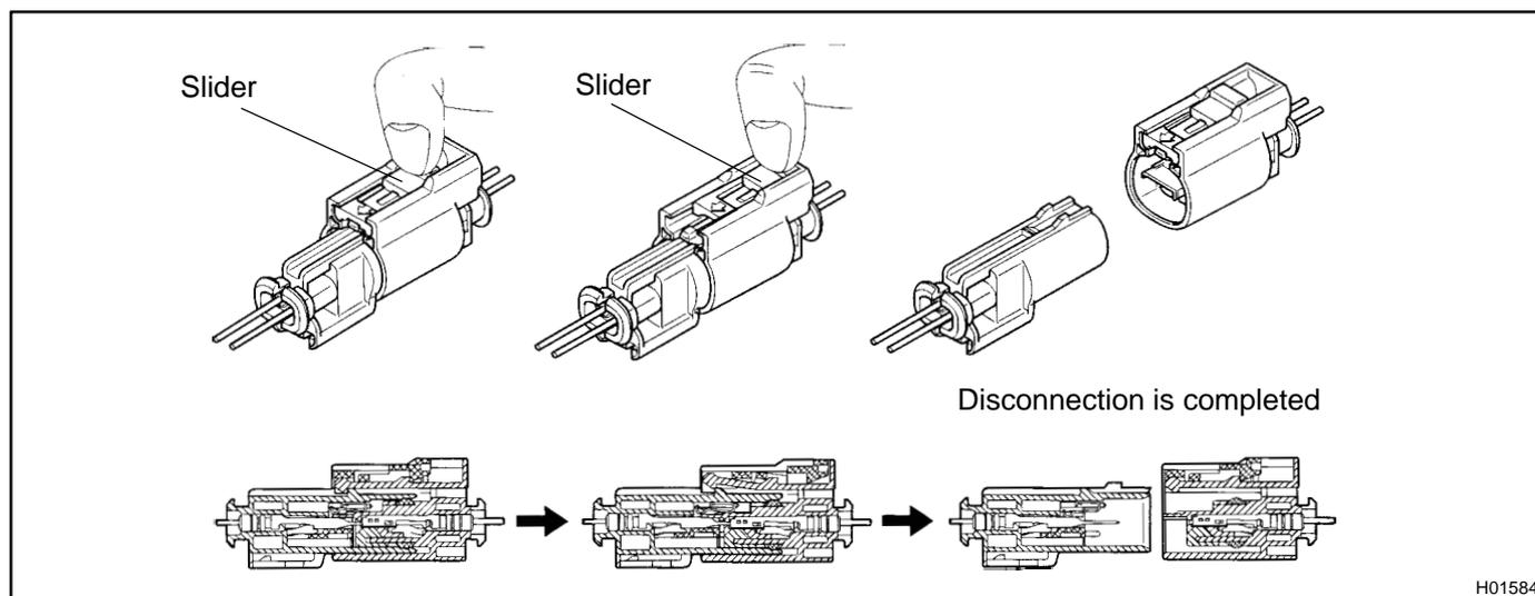
**13. CONNECTION OF SIDE AIRBAG CONNECTOR**
