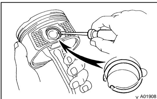
**26. DISCONNECT CONNECTING ROD FROM PISTON**
