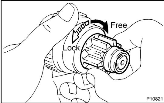
**13. INSPECT CLUTCH PINION GEAR**
