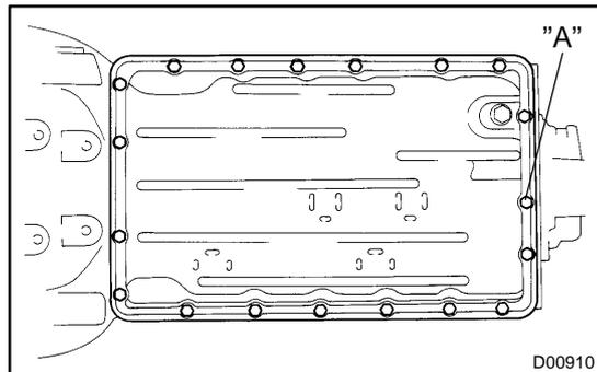
(d) Install the oil pan with the 19 bolts.
