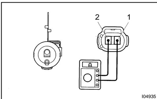
**5. INSPECT WIRELESS DOOR LOCK BUZZER OPERATION**
