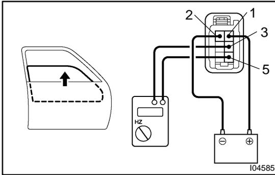
**29. Rear RH Door:****INSPECT JAM PROTECTION PULSE SWITCH**
