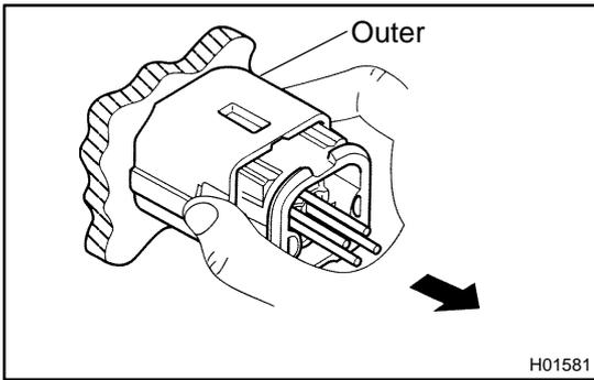
**10. DISCONNECTION OF SIDE AIRBAG SENSOR CONNECTOR**
