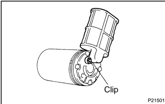
**9. REMOVE FUEL PUMP FILTER FROM FUEL PUMP**
