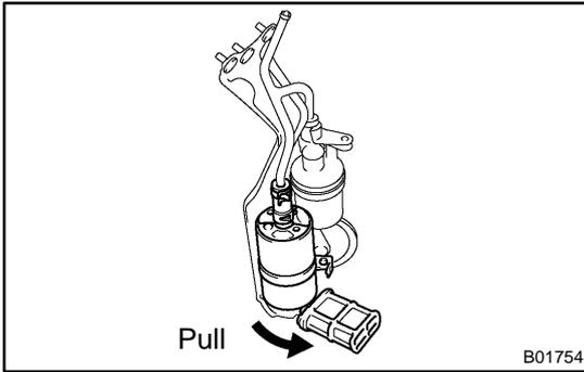
**8. REMOVE FUEL PUMP FROM PUMP BRACKET**
