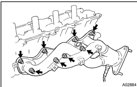
**27. REMOVE LH EXHAUST MANIFOLD FROM CYLINDER HEAD**
