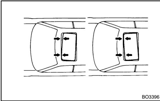
**5. ADJUST SLIDING ROOF GLASS IN CLEARANCE
