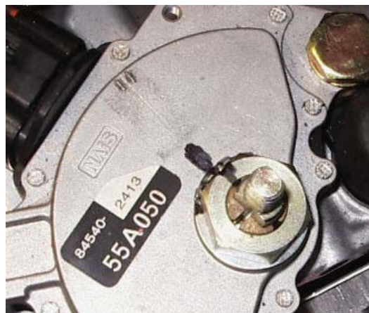
NSW con asta smontata, perno sfaccettato e tacche di riferimento a vista
