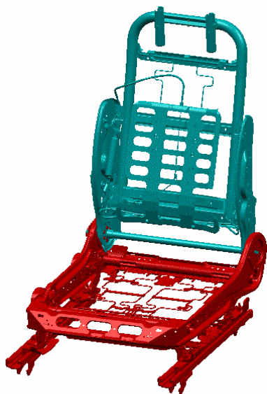
Sedile anteriore destro con alzasedile e basculamento
