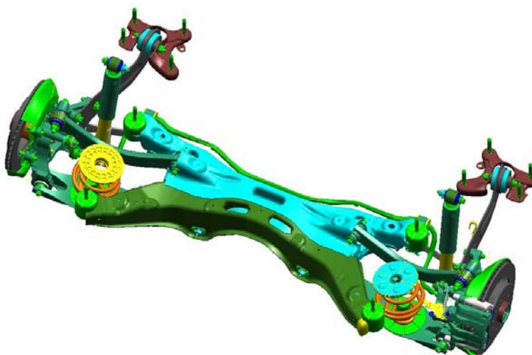
Sospensione posteriore completa
