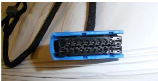
Particolare del connettore di interfaccia centrale – veicolo
