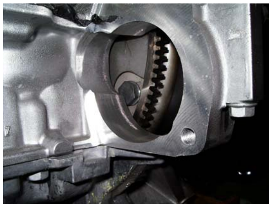
Foro per l'estrazione delle 3 viti del convertitore
