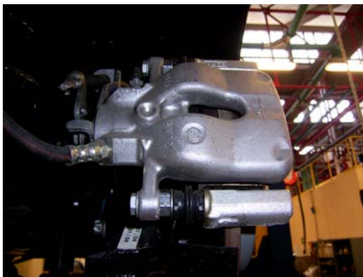
Pinza TRW realizzata in un unico blocco di fusione
