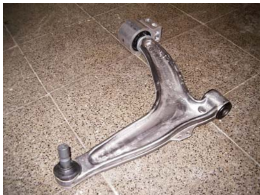
Braccio oscillante inferiore
