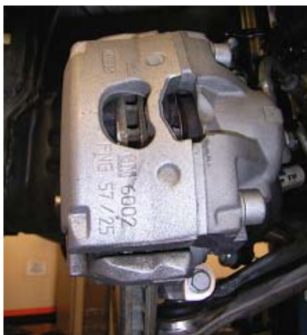
Pinza TEVES realizzata in due semigusci. In evidenza, le viti da non rimuovere
