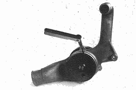
Fig. 29 - Gioco corpo e girante 0,9 \pm 0,2 mm Play between impeller and body 0.9 \pm 0.2 mm
