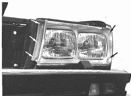
Fig. 14 - Viti di fissaggio cornice inferiore Lower trim screws
