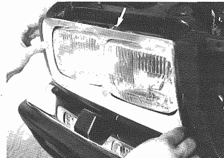
Fig. 16 - Prigionieri di fissaggio mascherina Template studs
