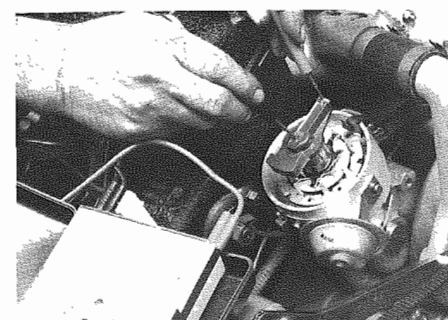
Fig. 5 - Verifica della continuità elettrica Checking the electric continuity
