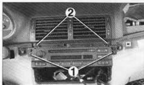
1. Tornillo de autoradio - 2. Tornillo de la salida de ventilación central.
