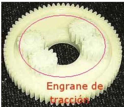
Este es el engrane de impulsión y sus engranes satelitales en el circulo rojo, su montaje no requiere cuidados especiales ya que acciona sobre engranes redondos, de preferencia montarlo como en la fotografía 2 anteriores
