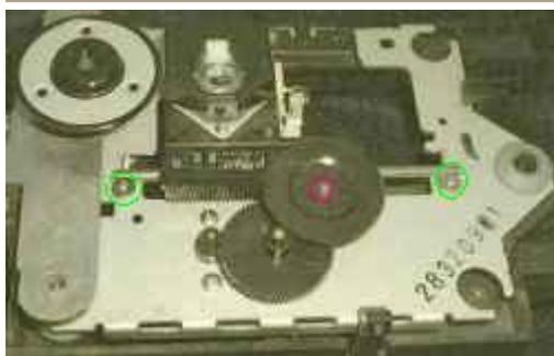
Aquí esta el ensamble óptico, para desmontar debes retirar el seguro marcado en rojo, retirar los tornillos marcados en verde, estos motores deben marcar una resistencia aproximada de 12 ohmios
