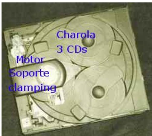
Este es nuestro mecanismo, antes que nada si la bandeja funciona pulsa open/close para sacar la bandeja y retira con cuidado el frente, si no funciona acciona la leva que se encuentra en la parte inferior casi al final de la parte trasera, con esto liberas la bandeja, empuja la bandeja hacia el frente, debes tener cuidado al desmontar el mecanismo, ya que antes debes desconectar 3 conectores de alambres delgados los cuales podrías dañar si los jalas.
