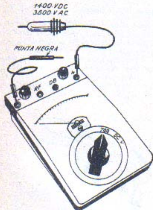
Fig. 49. — Posición para el rango 4. ubicación de puntas.
