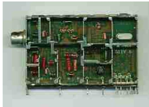
Otra falla muy común es la siguiente : El TV encuentra los canales del 2 al 6 pero del 7 al 13 no . Esto es debido a que no se realiza la conmutación de bandas. En cambio en los con sintetizador suelen ser soldaduras defectuosas alrededor del IC que hace las veces de sintetizador ( muy frecuente esto último ) . En los tipo varicap suelen dañarse los transistores encargados de esta tarea ubicado fuera del sintonizador , o bien el circuito que controla los mismos
