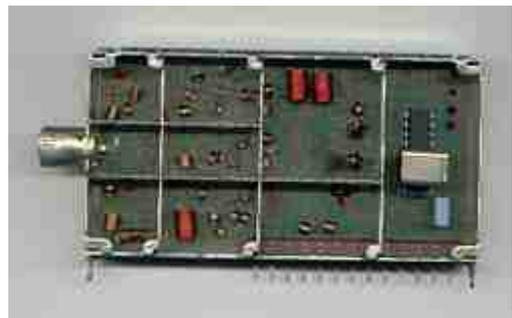
En los casos en que el sintonizador no requiera la tensión de 5 Volts es porque son los comunes a varicap (para los cuales se necesita la tensión de 33 Volts) . Debemos controlar las tensiones de conmutación de cada banda en este caso , las que vendrán indicadas en la serigrafía del impreso generalmente como BL , BH y BU . A estos los llamaremos simplemente : **a varicap**
