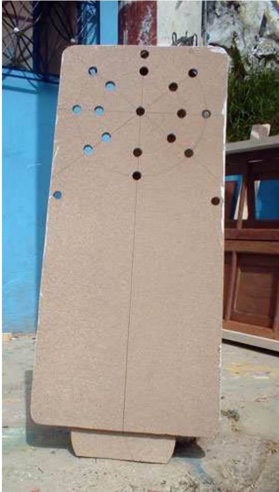
Puerta con perforaciones para chapas y pestaña para enganche inferior. además tiene orificios que sirven para ventilar el monitor.
