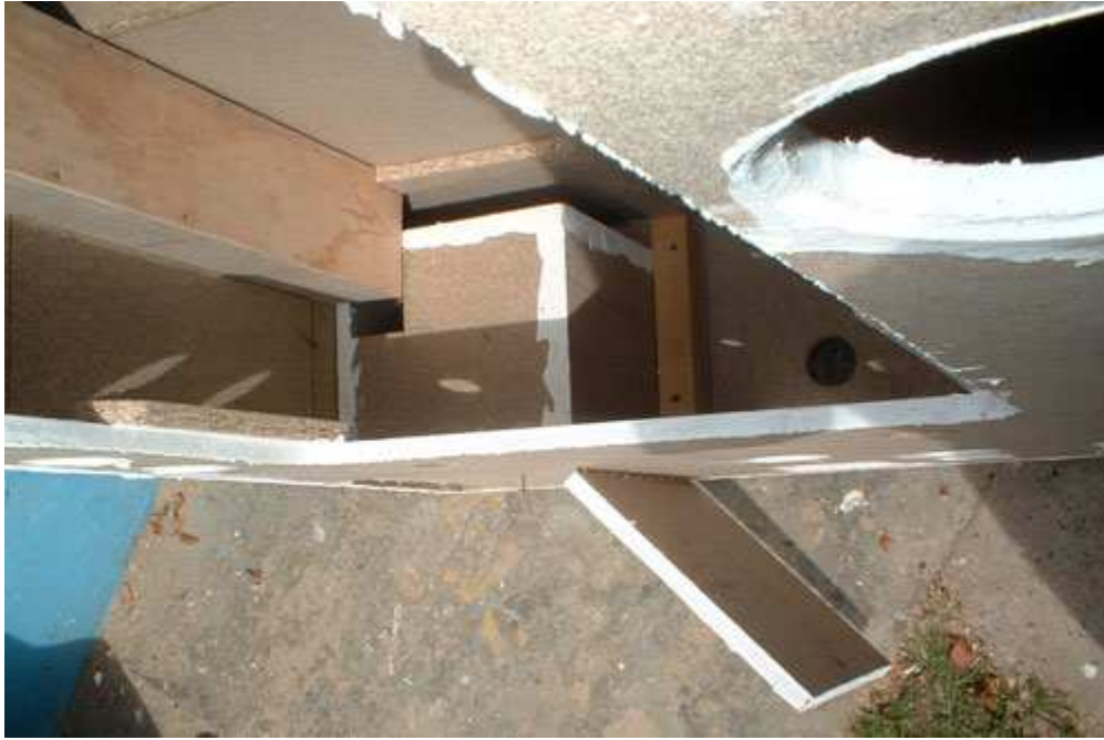
Ubicación del cajón de las monedas y puerta con bisagra.
