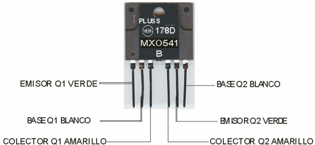
Este único elemento, el MX0541B-PLUSS puede sustituir a los transistores de las fuentes para TV SONY solucionando el problema que encuentran los centros de servicio técnico al comprar transistores de igual referencia, pero de características electrónicas diferentes, los cuales por deriva térmica entran en avalancha poniéndose en corto después de poco tiempo de trabajo.
