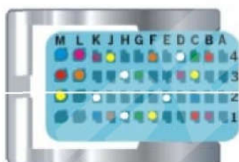
CONECTOR A (lado do chicote) VISTA TRASEIRA
