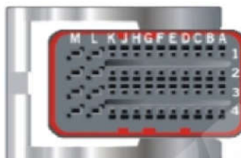
CONECTOR B DA UCE (lado do chicote) VISTA FRONTAL
