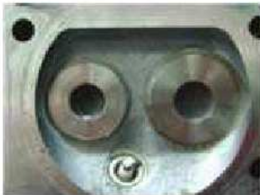
Cámara de combustión motor 1.0 HPP LF
