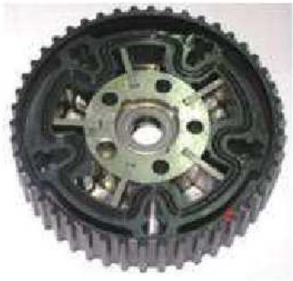
Rotor del variador con paletas
