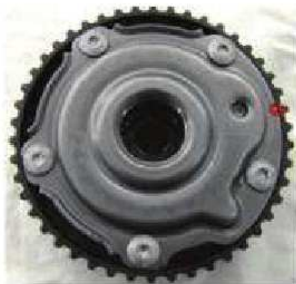
Polea del comando de válvula con variador
