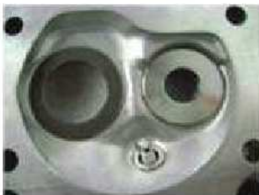
Cámara de combustión motor 1.4 EVO
