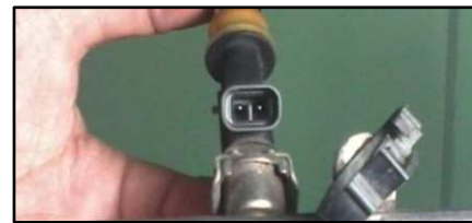
Figura 13. Inyector Delphi
