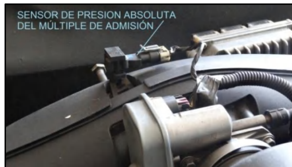
Figura 4.9. Localización del sensor MAP
