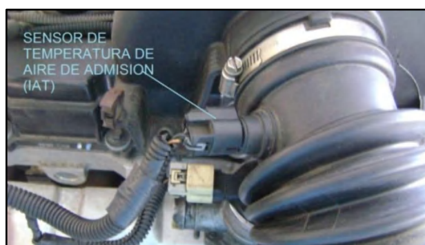
Figura 4.6. Localización del sensor IAT
