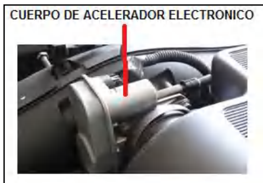
Figura 2.15. Cuerpo de aceleración electrónico
