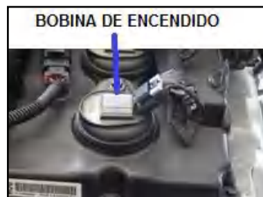
Figura 2.57. Bobinas de encendido
