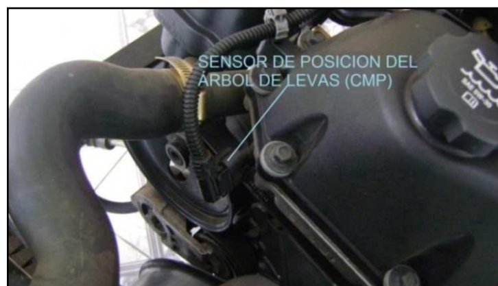
Figura 2.32. Sensor CMP
