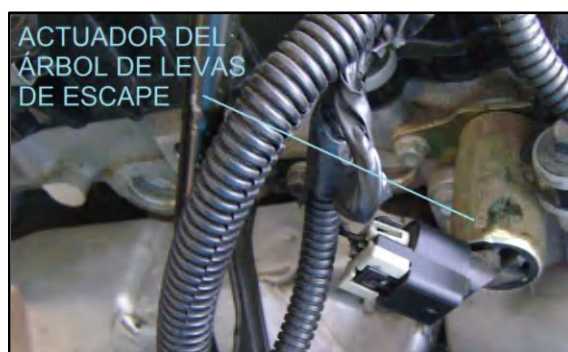
Figura 4.49. Localización del actuador del árbol de levas
