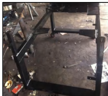
Figura 4.1 Estructura del banco de pruebas
