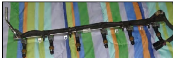
Figura 4.35. Riel de inyectores
