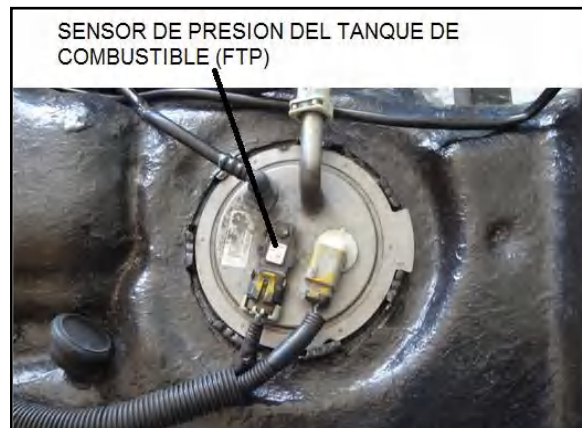
Figura 2.25. Sensor FTP
