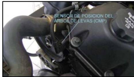
Figura 4.17. Localización del sensor CMP
