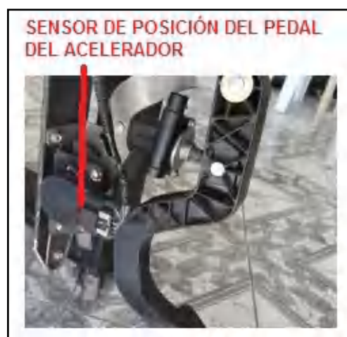
Figura 4.26. Localización del sensor APP
