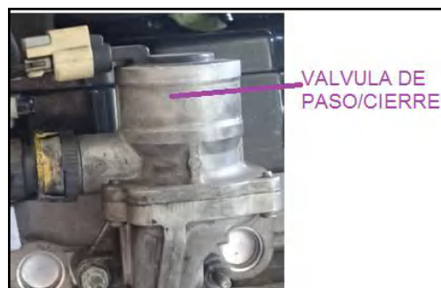
Figura 2.55. Válvula de paso/cierre de aire
