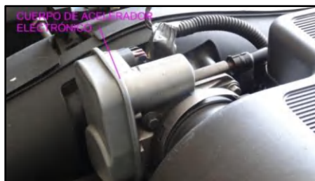
Figura 12. Cuerpo de aceleración electrónico
