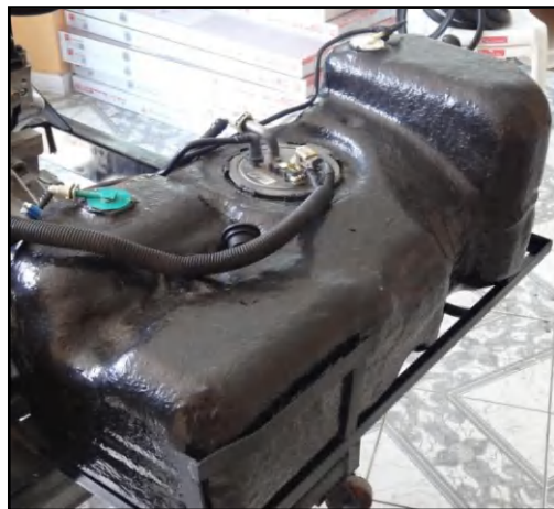
Figura 2.5. Tanque de combustible modificado
