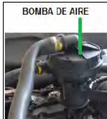
Figura 2.54. Bomba de aire secundario
