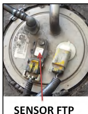
Figura 4.42. Localización del sensor FTP
