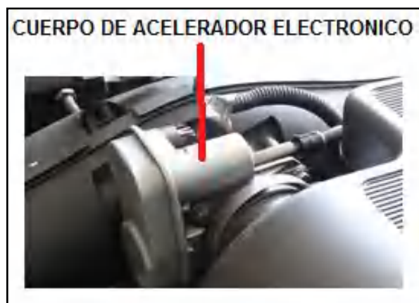
Figura 4.28. Localización del cuerpo de aceleración electrónico
