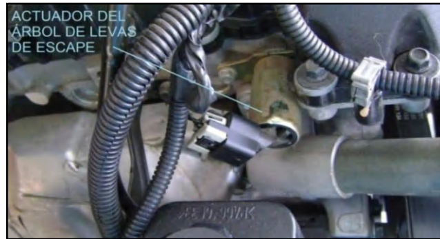
Figura 2.53. Actuador del árbol de levas de escape
