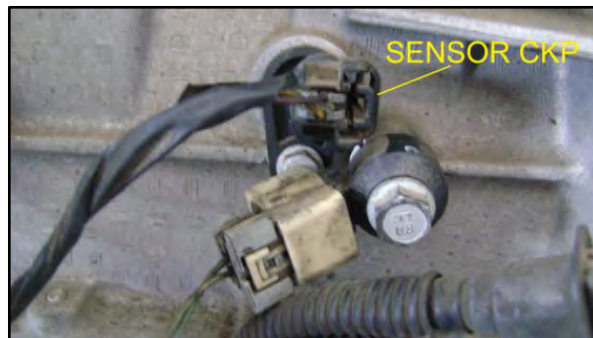
Figura 4.12. Localización del sensor CKP
