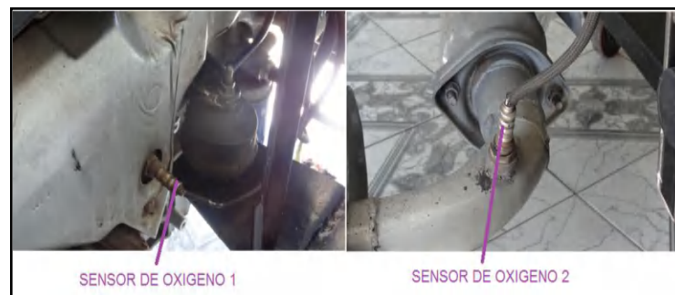
Figura 2.40. Localización sensores de oxígeno
