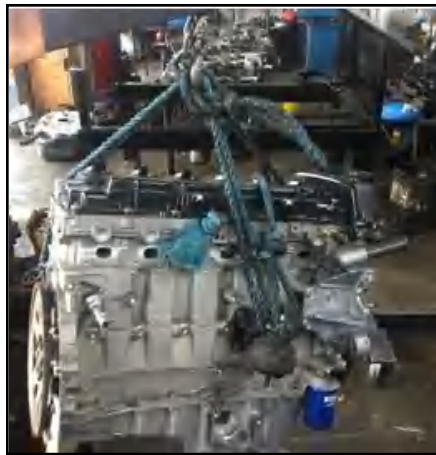
Figura 4.2 Montaje del motor en la estructura
