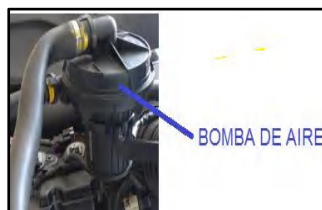
Figura 6. Bomba de aire auxiliar
