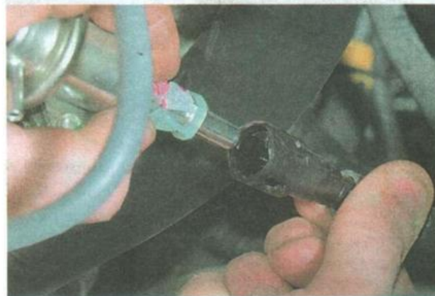
13. Аналогичным образом отсоединяем подающий топливопровод.
