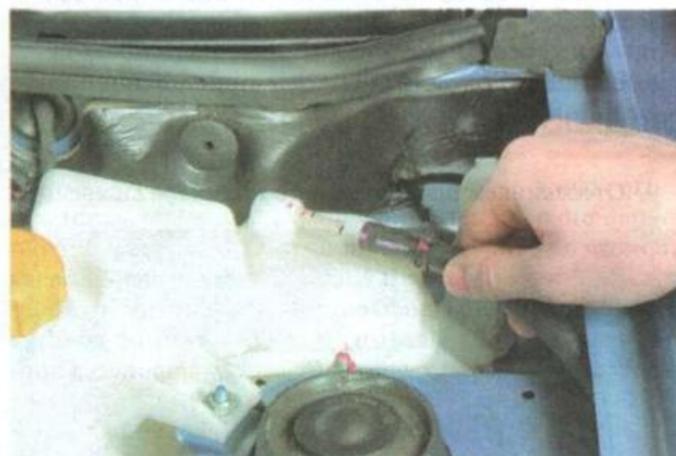
6. Аналогичным образом отсоединяем шланг подогрева дроссельного узла.
