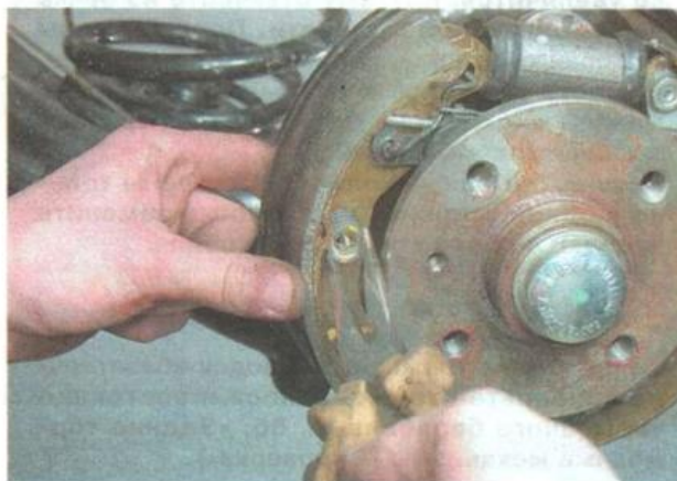
7. Придерживая опорную стойку с обратной стороны, длинногубцами надавливаем на чашку и поворачиваем ее на 90°.
