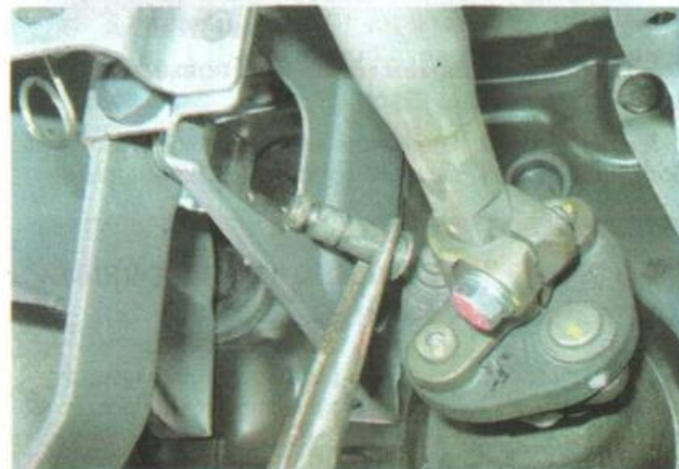
4. Извлекаем ось штока главного цилиндра выключения сцепления.
