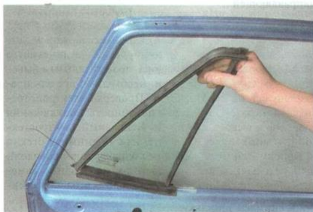
12. Сдвигая стекло назад и немного приподнимая задний край, выводим его из зацепления с механизмом стеклоподъемника...
