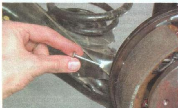
10. Аналогично снимаем опорную стойку задней тормозной колодки.
