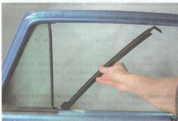
11. Снимаем неподвижное стекло задней двери.
