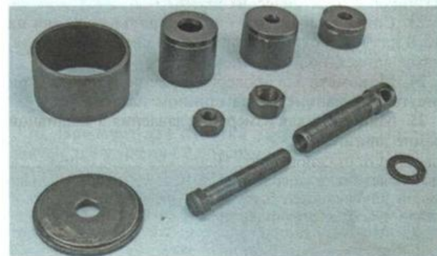
17. Рассухариватель для сжатия пружин клапанов механизма газораспределения.
