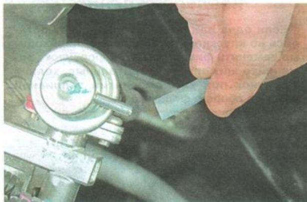
12. Сжимаем фиксатор и отсоединяем от топливной рампой сливной топливопровод.
