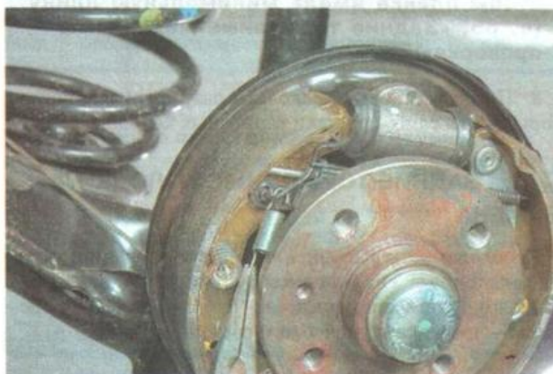
7. Придерживая опорную стойку с обратной стороны, длинногубцами надавливаем на чашку и поворачиваем ее на 90°.
