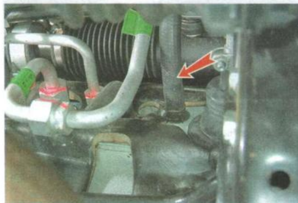
...и второй шланг, идущий к головке блока цилиндров.
