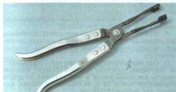
14. Приспособление для замены маслосъёмных колпачков.
