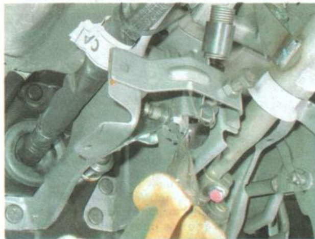
4. Извлекаем ось штока главного цилиндра выключения сцепления.
