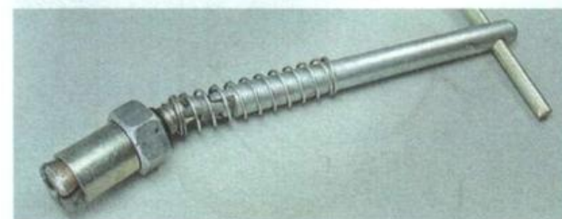
18. Приспособление для притирки клапанов.
