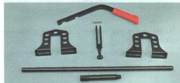
18. Приспособление для притирки клапанов.
