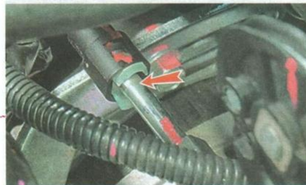
14. Ключом на 10 мм выворачиваем два болта крепления топливной рампой.
