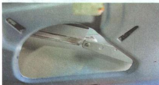
12. Сдвигая стекло назад и немного приподнимая задний край, выводим его из зацепления с механизмом стеклоподъемника...
