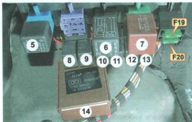
Нижняя часть блока предохранителей и реле
