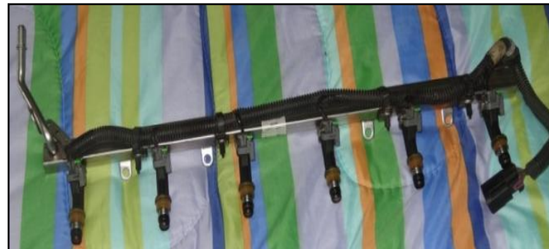
Figura 34. Inyectores de combustible
