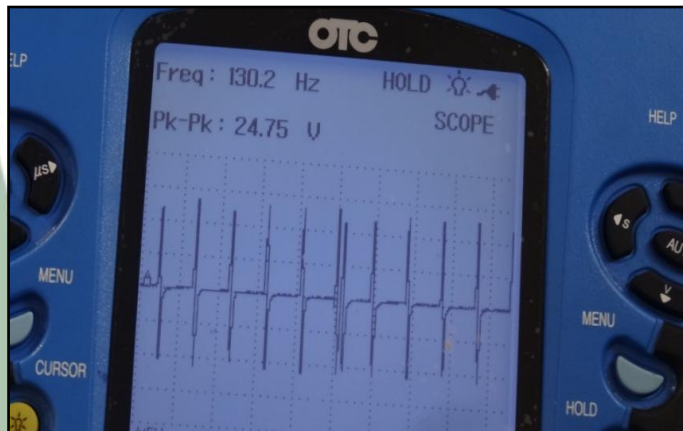
Fuente: Los autores Figura 7. Curva del sensor CKP en ralentí
