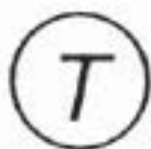
Boca, para teléfono de servicio externo
